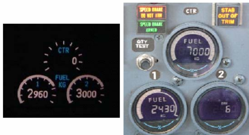
Figure 231 – Instrumentos de indicação de quantidade de combustível
