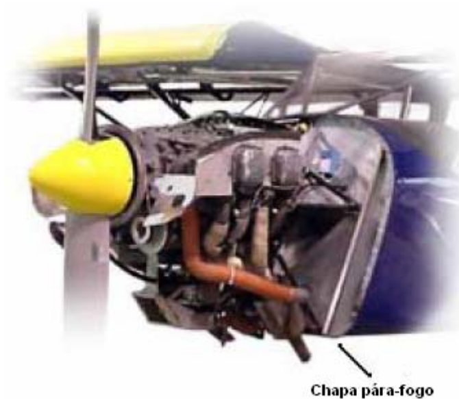
Figura 264 – Chapa pára-fogo de um avião monomotor
