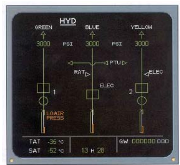
Figura 205 – Monitorização do sistema hidráulico
