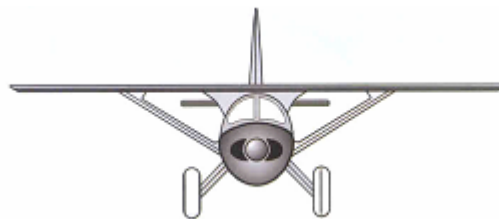
Figura 40 – Fixação da asa tipo semi-cantiliver
