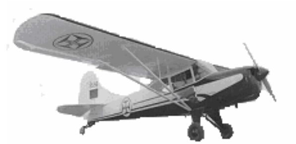
Figura 41 – Fixação da asa tipo contraventada
