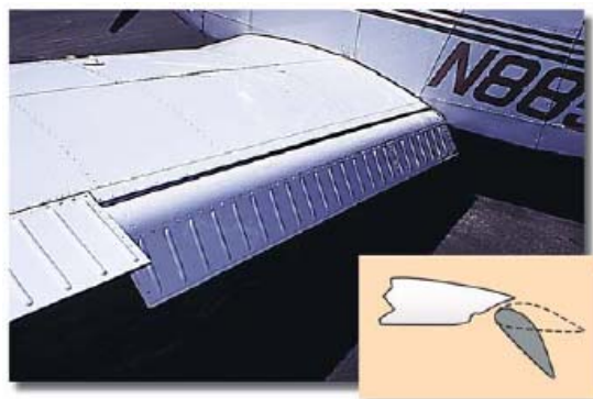
Figura 103 – Flap com fenda
