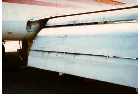
Figura 107 – Flap extensível com fendas múltiplas
