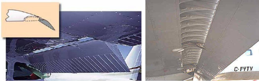
Figura 105 – Flap extensível com fenda
