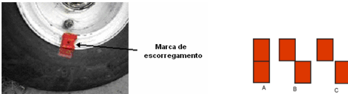
Figura 147 – Marcas de escorregamento
