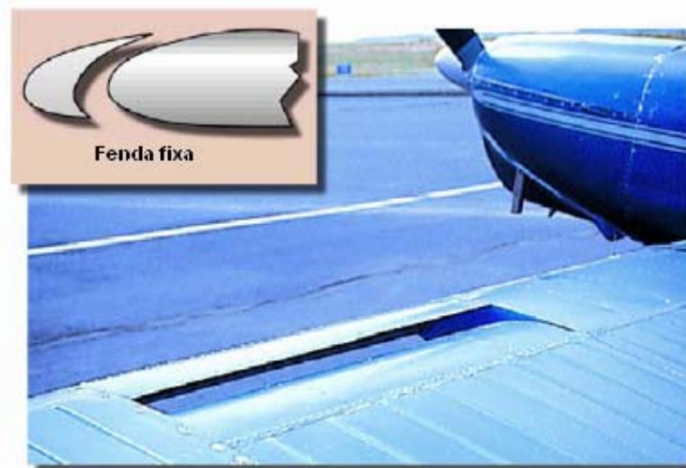
Figura 110 – Fenda de bordo de ataque fixa
