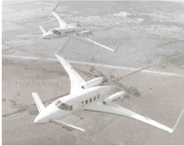
Figura 25 – Fuselagem integralmente construída com materiais compósitos
