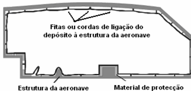
Figura 209 – Depósito de combustível flexível
