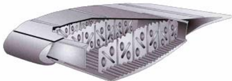
Figura 56 – Construção tipo caixa de torção
