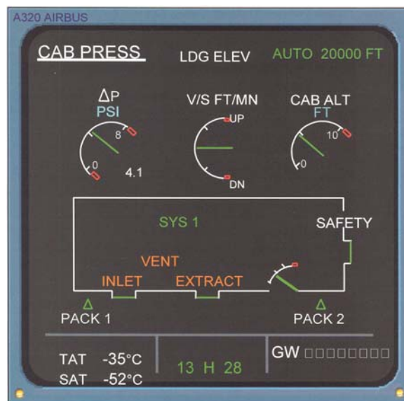
Figura 251 – Sistema digital de indicação da pressurização
