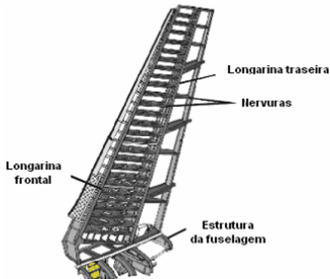
Figura 59 – Estrutura do estabilizador vertical
